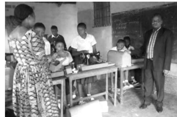
Für den Einsatz in der Demokratischen Republik Kongo sind diese Maschinen wesentlich besser geeignet, als moderne elektrische Maschinen, weil sie unabhängig von der höchst unzuverlässigen Stromversorgung im Kongo sind.
